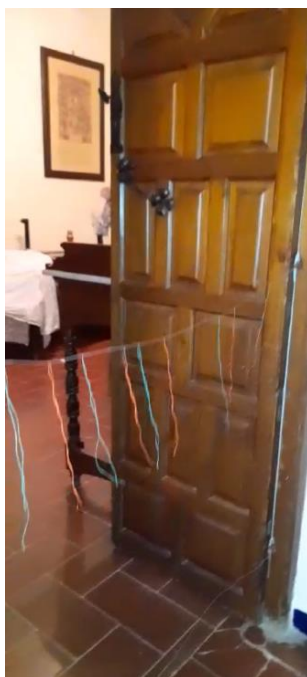
Ilustración 31: Instalación de alambre e hilos para experimento sentido de la corriente de aire
