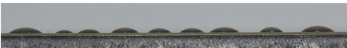
Figura 104. Imagen de gotas depositadas sobre Ti-G1
