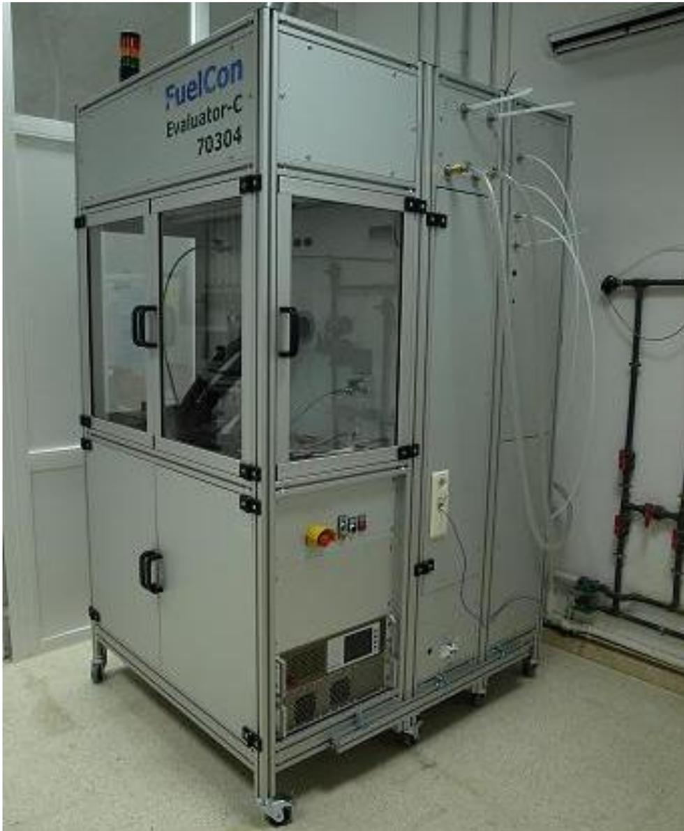
Figura 29. Vista general del banco de ensayos de monoceldas de FuelCon.
