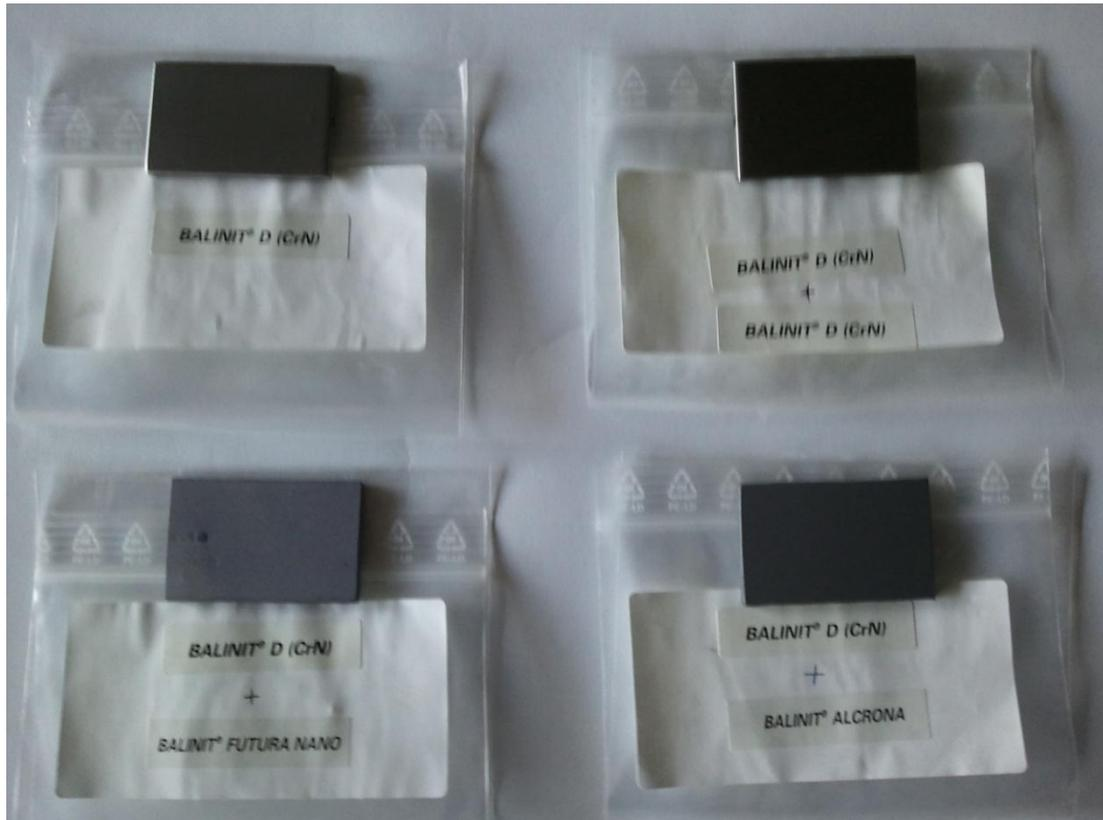
Figura 98. Muestras de placas de Al-1050 con diferentes recubrimientos basados en nitruros.
