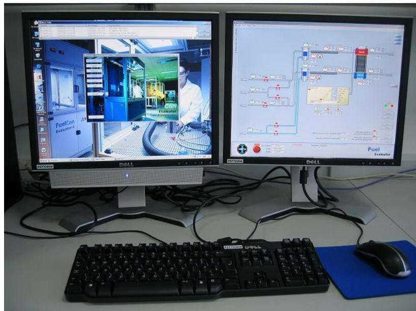
Figura 33. Puesto de control con la aplicación de adquisición de datos y control de la operación de la monocelda.
