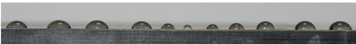
Figura 102. Imagen de gotas depositadas sobre E-Phen 1105
