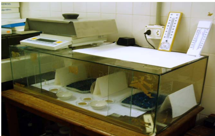
Figura II.33. Cámara de secado para filtros.
