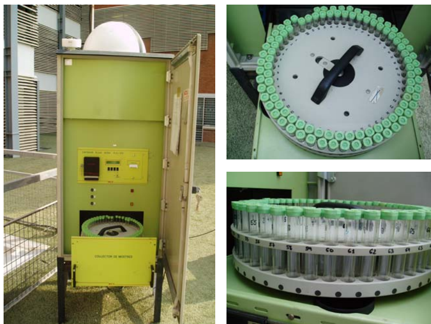
Figura II.25. Muestreador secuencial de agua de lluvia.
