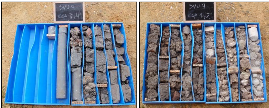
Figura 5.25. Sondeo SVU9 alojado en sus cajas de PVC durante el procesado y muestreo de materiales.
