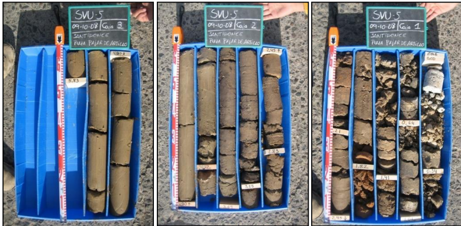
Figura 5.13. Testigo en caja de PVC del sondeo SVU5 una vez terminada su ejecución.
