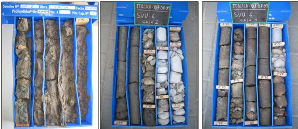
Figura 5.16. Material procedente del sondeo SVU6 alojado en las cajas portatestigos.
