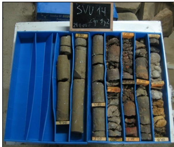
Figura 5.33. Testigo del sondeo SVU14 alojado en cajas.
