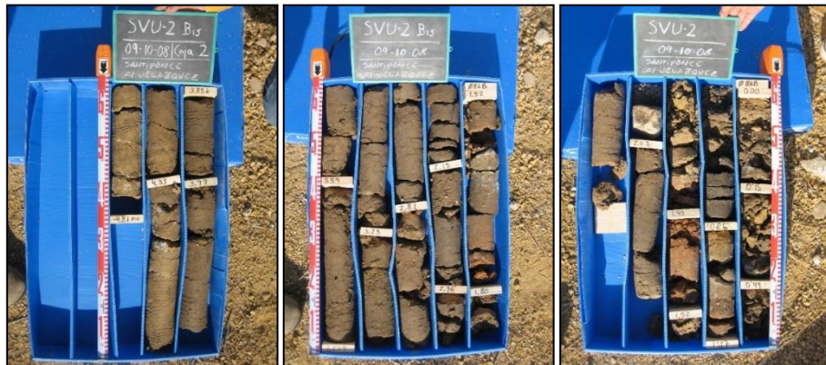
Figura 5.4. Testigo en caja de PVC procedente del sondeo SVU2 una vez terminada su ejecución.
