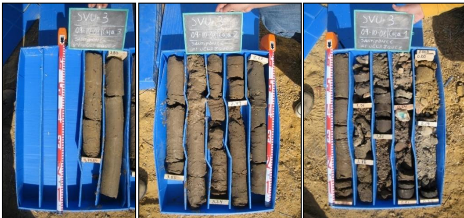
Figura 5.7. Testigo del sondeo SVU3 alojado en caja de PVC tras su extracción.
