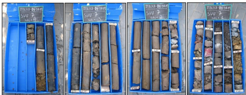
Figura 5.19. Testigo obtenido en la perforación SVU7 dispuesto en las cajas de PVC para su estudio.
