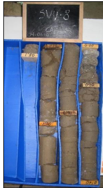
Figura 5.22. Testigo en caja de PVC del sondeo SVU8 una vez extraído.
