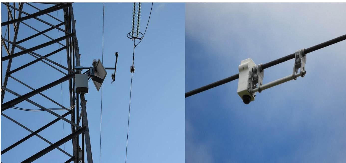
Fig. 3. Estación meteorológica (izquierda) e inclinómetro (derecha) instalados en la línea Logroño-El Sequero.
