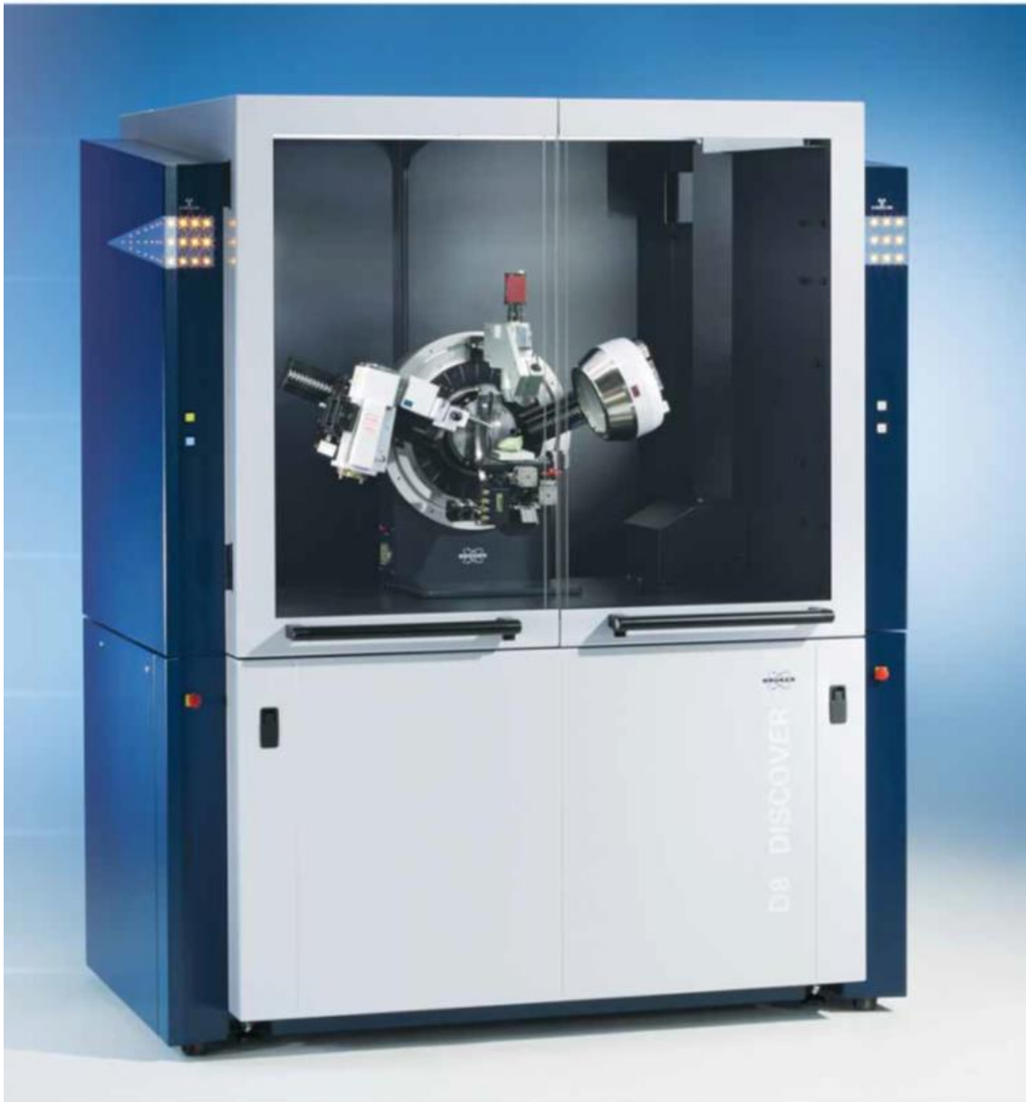
Figura 8. Difractómetro D8 Discover A25 para estudio de capas y superficies. [9].
