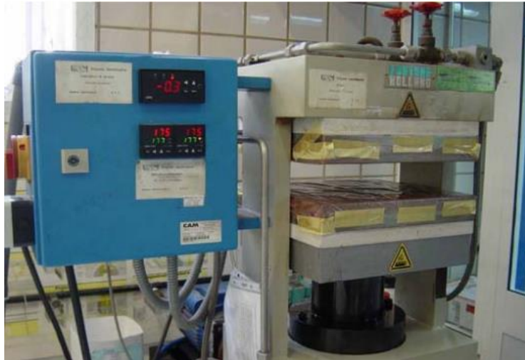
Fig. 25- Prensa de platos calientes utilizada para el curado del adhesivo [9].
