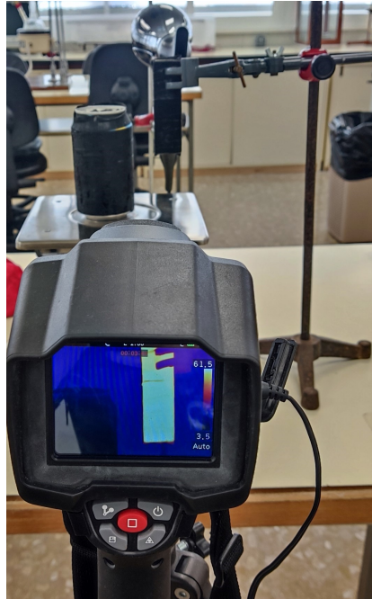
Figura 12: Grabación del enfriamiento por convección forzada con aire frío de la placa de hierro mediante la cámara termográfica KCTE-384.
