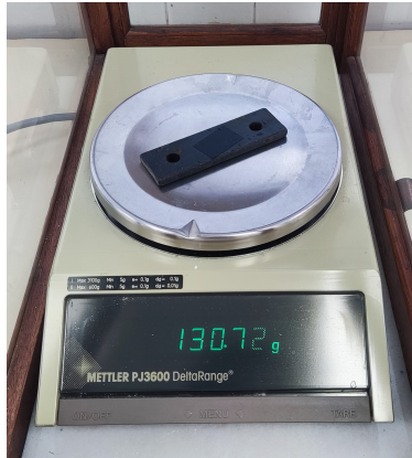
Figura 10: Masa de la placa de hierro medida en una balanza de precisión 0.01g.
