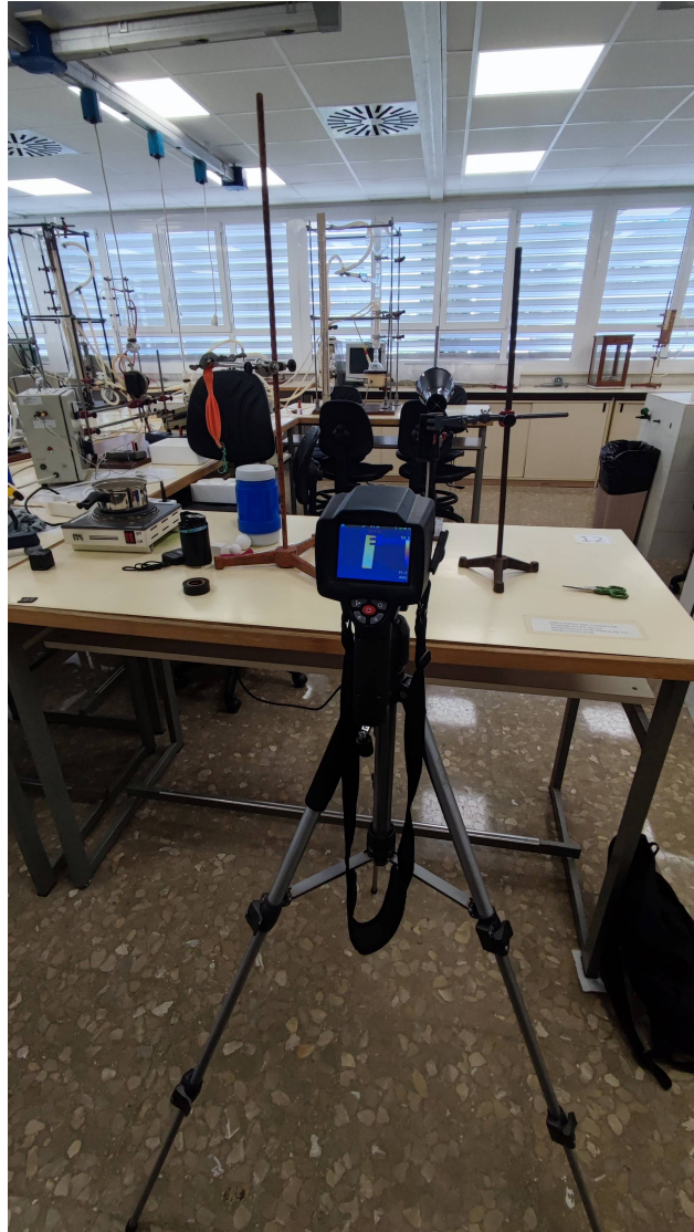
Figura 29: Cámara termográfica junto al trípode ultralight en el proceso de la toma de medidas en el laboratorio de Termodinámica (Facultad de Física).
