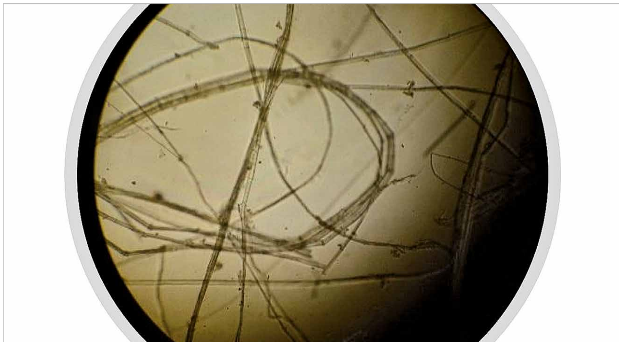
Figura 9. Fibras textiles de lino extraídas de la muestra SF2. (microscopía óptica, 200x). Fuente: Proyecto Prometeo (20150387 BP).
