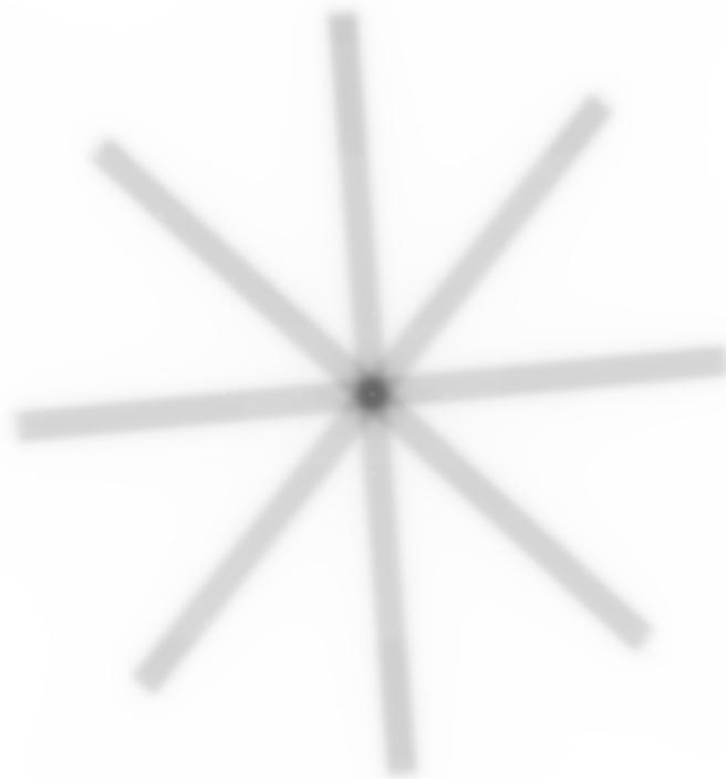
Figura 3.1: Estrella de radiación usada para verificar el sistema MLC del acelerador lineal. (Cortesía del Servicio de Radiofísica del HUVM)
