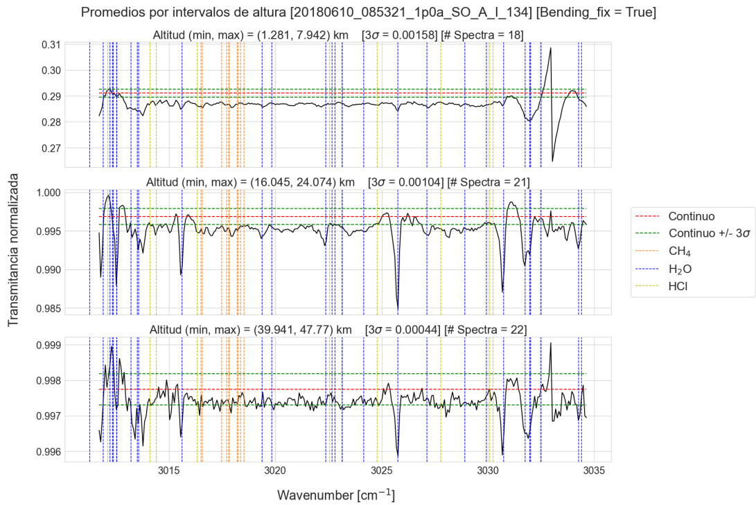
Figura 16: Efecto del filtrado de baja frecuencia mediante la transformada wavelet en los promedios del scan 5: 20180610_085321.
