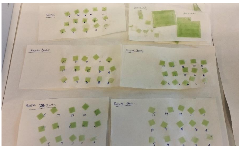
Figura 21. Cuadrados impresos para medir la profundidad de curado para las distintas mezclas preparadas. Comenzando desde arriba a la izquierda: cuadrados de resina 0wt%, escalera de resina 0wt% (descartada), cuadrados de resina 8wt%, cuadrados de resina 4wt%, cuadrados de resina 23,2wt% (descartada), cuadrados de resina 16wt%
