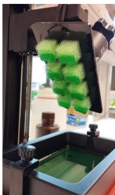
Figura 6. Objetos impresos soltando el exceso de resina tras su impresión 3D
