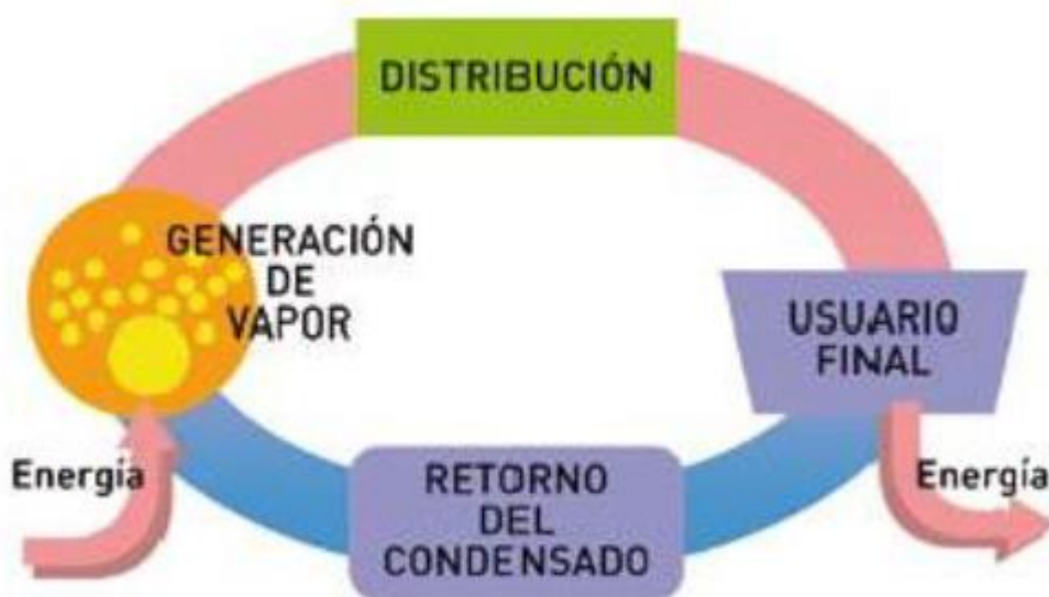
Figura 1. Esquema de una instalación de vapor [1].
