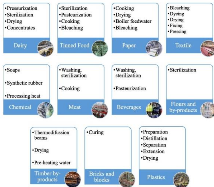
Figura 11: Procesos industriales a los que se le podría aplicar un sistema de Energía solar Térmica. [1]
