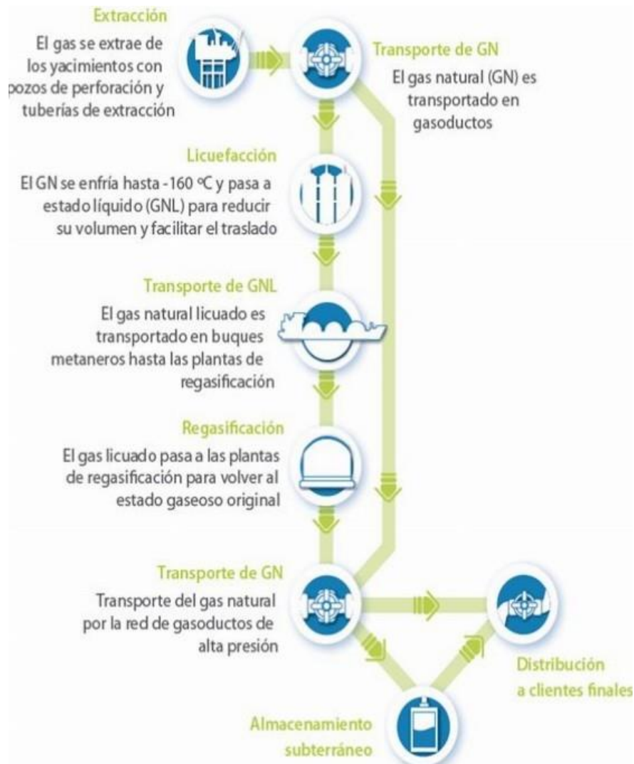
Figura 7_ Ciclo del gas regasificado. Fuente: Enagás
