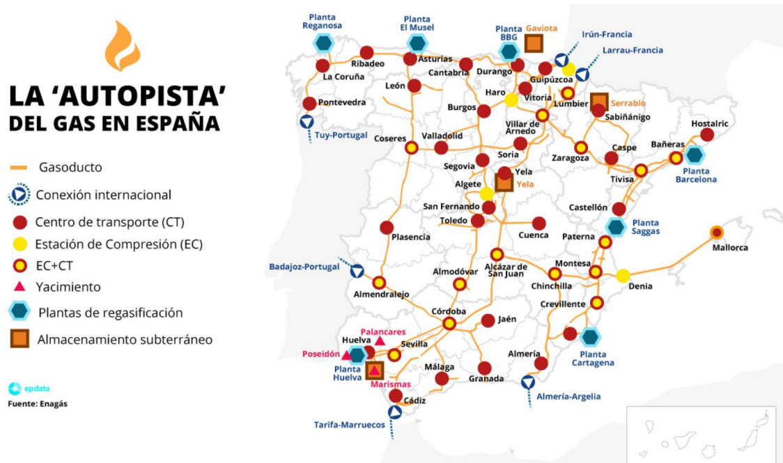
Figura 3_ Representación de los gasoductos, conexiones internacionales, yacimientos, almacenamientos subterráneos y plantas de regasificación en España. Fuente: Enagás.
