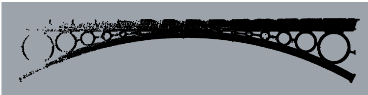
Figura 34: Nube de puntos escaneada de la parte de hierro. Fuente: elaboración propia en Rhino
