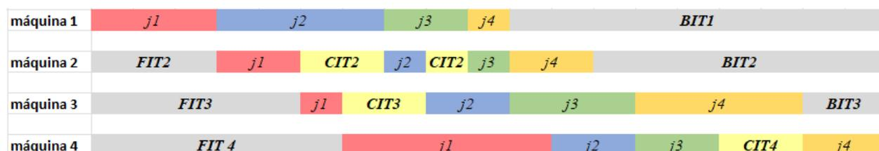
Figura 3. Idle time en un entorno Flow shop
