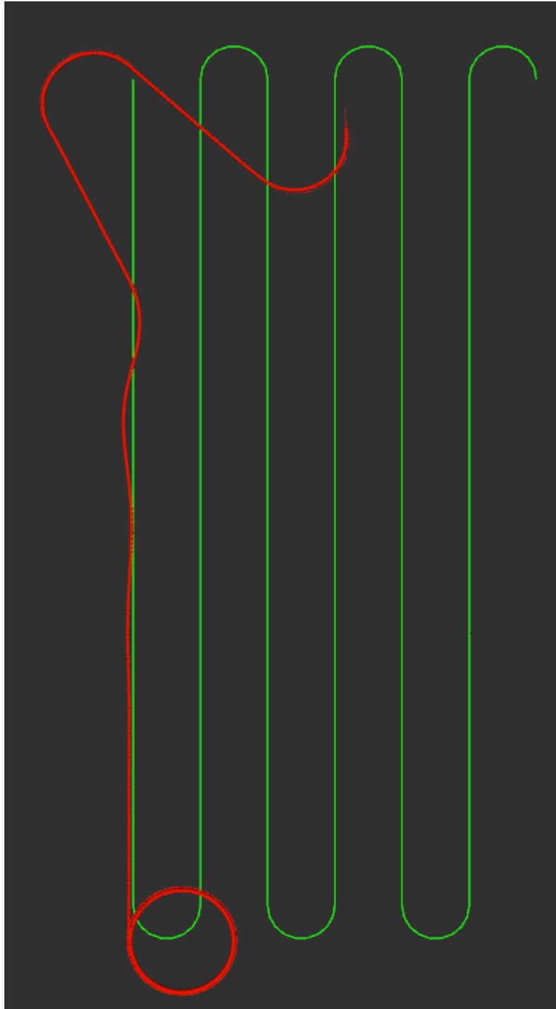
Figura 32 - Comportamiento del robot para  $v = 1$  m/s y  $L = 1.3$  m
