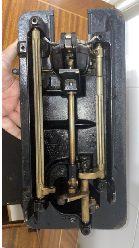
Ilustración 11 Ensamblaje de la base de la máquina: los tres ejes y el eje guía
