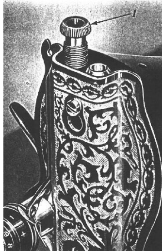
Figura 2.12 Reglaje de la presión del pie prensatelas
