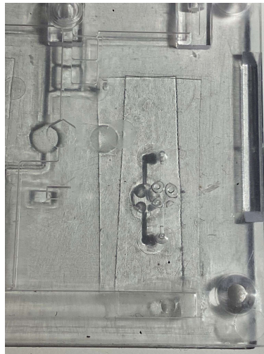
Ilustración 25 Ejemplo de burbujas en los canales del LOC
