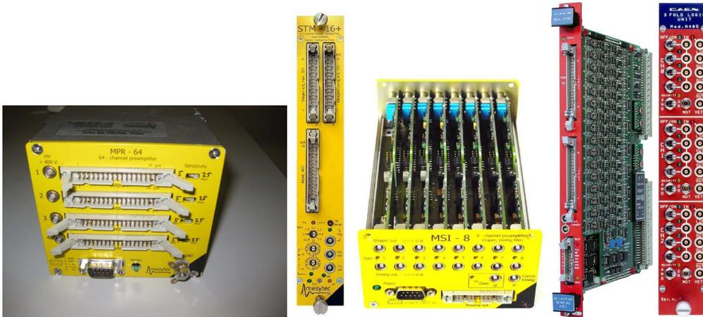
**Figura 3.14:** Electrónica utilizada durante el experimento E1104, de izquierda a derecha. Módulo pre-amplificador MPR-64. Módulo amplificador STM-16+. Módulo preamplificador-amplificador MSI-8. Módulo ADC Caen V785. Módulo lógico FLU (*Folding Logic Unit*) Caen N405.
