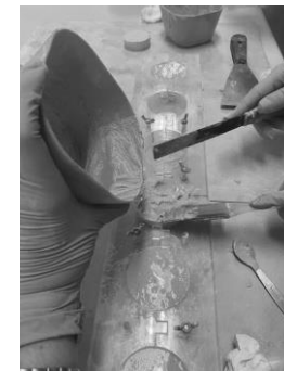
Imagen 17. Vertido de la mezcla en las probetas de ensayo térmico. Fuente: elaboración propia.
