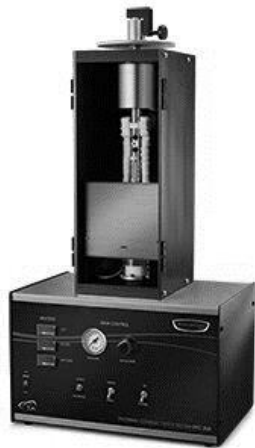
Imagen 19. Máquina de ensayo térmico DTC 300. Fuente: elaboración propia.
