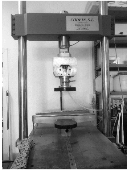
Imagen 7. Prensa multi-ensayo de 300kN Codein S.L., modelo MCO-30, número de serie 139. Fuente: elaboración propia.
