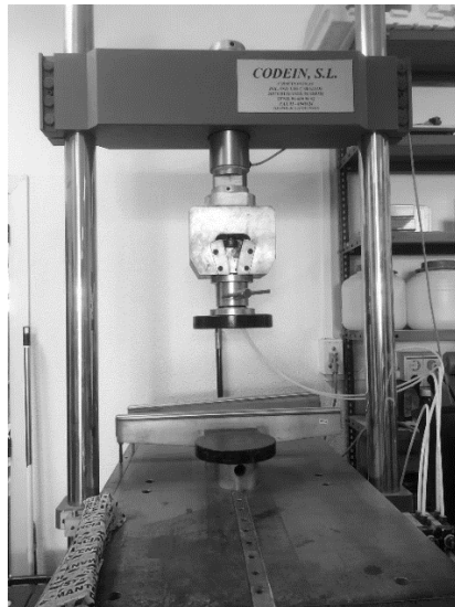
Imagen 78 Prensa multi-ensayo de 300kN Codein S.L., modelo MCO-30, número de serie 139. Fuente: elaboración propia.
