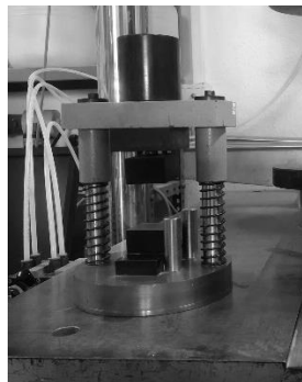
Imagen 9. Complemento para el ensayo de resistencia de rotura a flexión. Fuente: elaboración propia.
