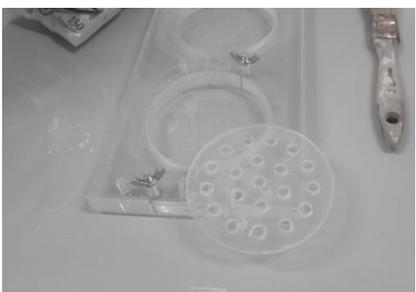
Figura 42. Proceso de fabricación de las probetas de yeso para la realización de ensayos acústicos. Fuente: TFG año 2021/2022 [10]
