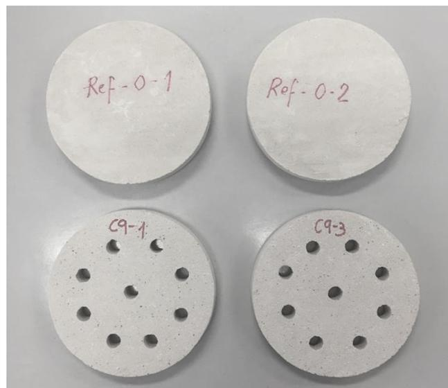
Figura 40. Probetas de referencia (sin perforaciones) y con 9 perforaciones para la realización de ensayos acústicos. Fuente: Elaboración propia.
