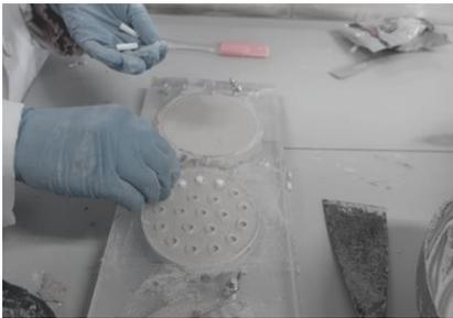
Figura 43. Proceso de fabricación de las probetas de yeso para la realización de ensayos acústicos.
