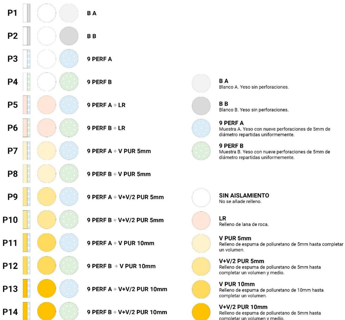
Figura 54. Esquema configuración probetas. Fuente: Elaboración propia.
