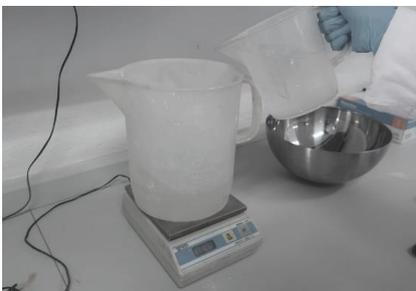
Figura 41. Proceso de fabricación de las probetas de yeso para la realización de ensayos acústicos. Fuente: TFG año 2021/2022 [10]
