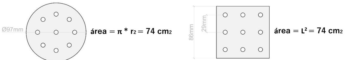
Figura 75: Relación de áreas entre probeta circular y cuadrada. Fuente: elaboración propia.
