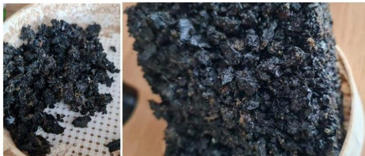
Figura 26: Gránulos de caucho de fracción gruesa utilizados como absorbente. Fuente: Estudio de referencia [7]
