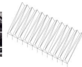
Fig. 22: Esquema plegadura con conicidad en Universidad Laboral Tarragona
