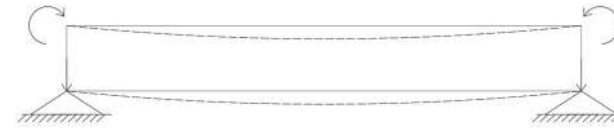
Fig. 10. Funcionamiento del sistema biapoyado
