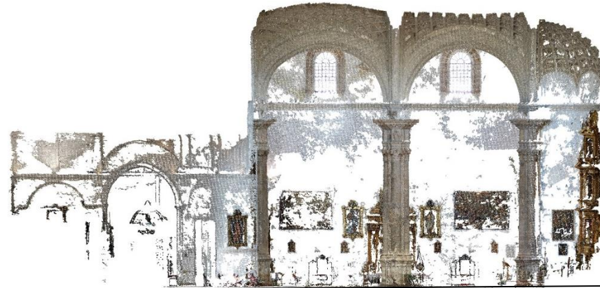
Fig. 3.2. Planta, secciones transversales y secciones longitudinal obtenida a partir de secciones de la nube proyectadas en planos ortogonales entre sí (autor)
