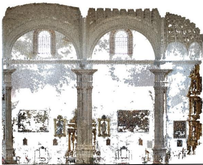
Fig. 3.8. Sección de las dos bóvedas centrales en la nube de puntos. (Autor)
