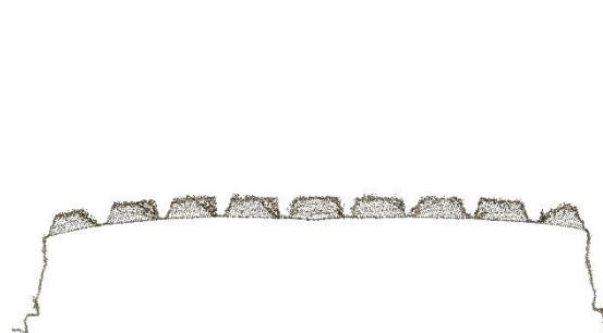
Fig. 3.12. Sección de nervio de la primera bóveda central de la iglesia de Cazalla (Autor)
