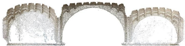
Fig. 3.6. Sección transversal por el centro del primer tramo de las bóvedas (Autor)
