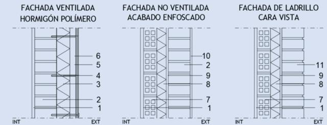
Figura 20. Detalles constructivos de los cerramientos. Fuente: autoría propia.
