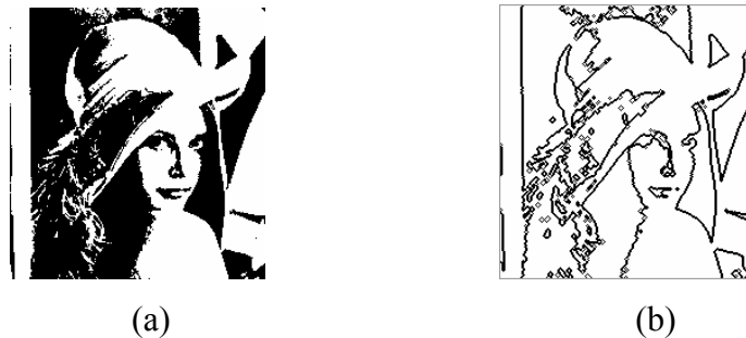
Figura 5.12. (a) Imagen binaria de Lena, (b) detección de bordes
