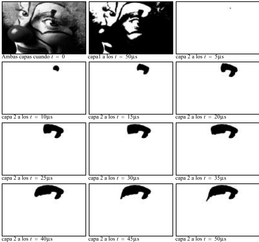
FIGURA 51. Detección de contorno en las CNN de 2 capas ( \tau_1 = 1\mu s y \tau_2 = 1\mu s ).
