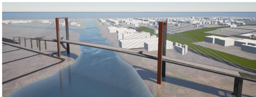
Figura 116. Fase 15: Cierre en clave. (Fuente: Elaboración propia)
