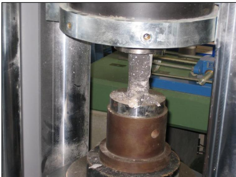
Ilustración 1-9 Ensayo de compresión simple en roca [12].
