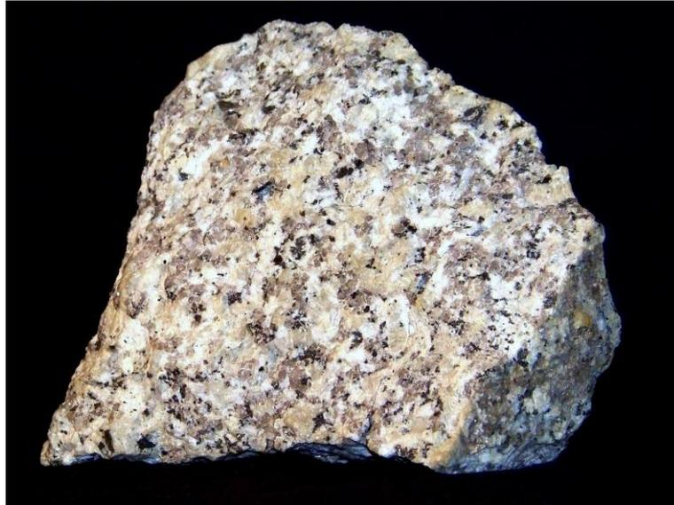
Ilustración 1-2 Roca ígnea plutónica (granito) [5].
