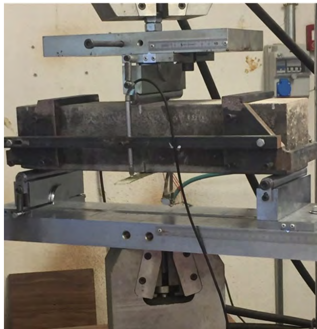
Figura 4. Ensayo a flexión en tres puntos.
