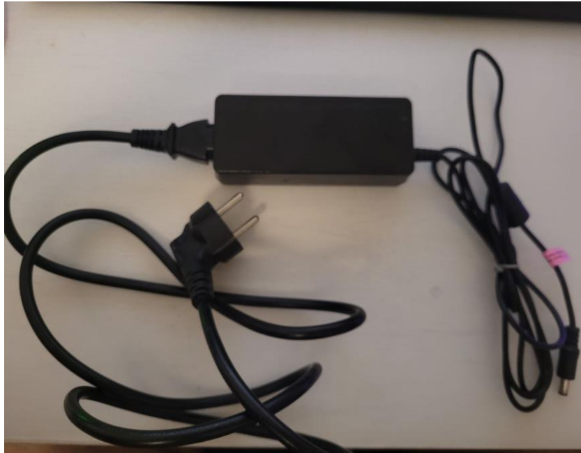
Figura 6. Fuente de alimentación modelo GS60A24 de MEAN WELL.
