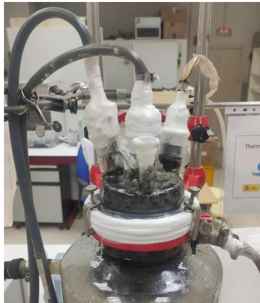
Ilustración 12. Tapa digestor anaerobio. Fuente: propia
