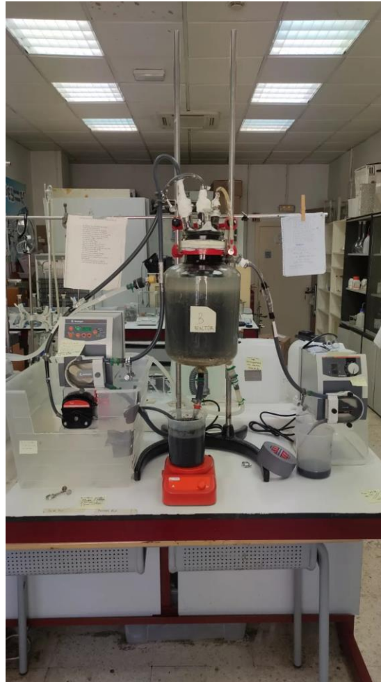
Ilustración 19. Digestor anaerobio mesófilo de laboratorio. Fuente: propia
