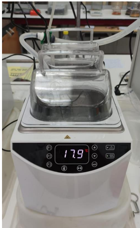
Ilustración 16. Activación y prueba del baño térmico. Fuente: propia
