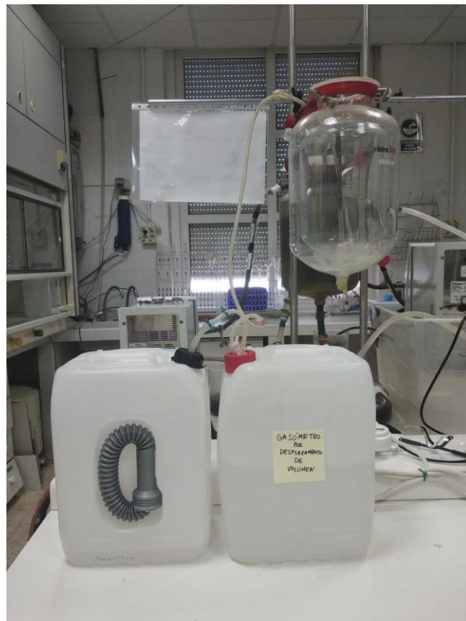
Ilustración 18. Gasómetro por desplazamiento de volumen. Fuente: propia
