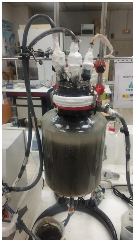
Ilustración 11. Digester anaerobio encamisado. Fuente: propia
