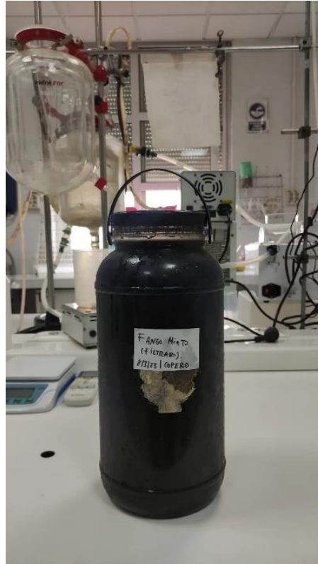
Ilustración 17. Almacenamiento en recipiente plástico de fangos mixtos filtrados. Fuente: propia
