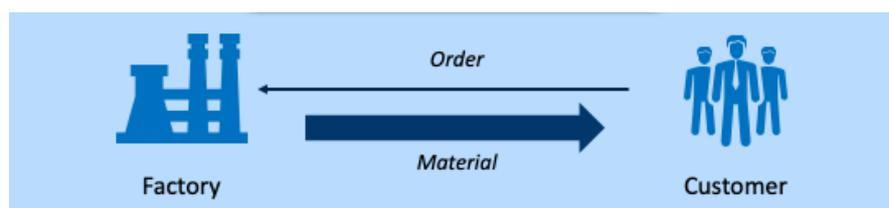
Figura 2.5. Sistema de fabricación contra pedido (MTO) [Fuente: <https://www.sketchbubble.com/en/presentation-make-to-stock.html>]
