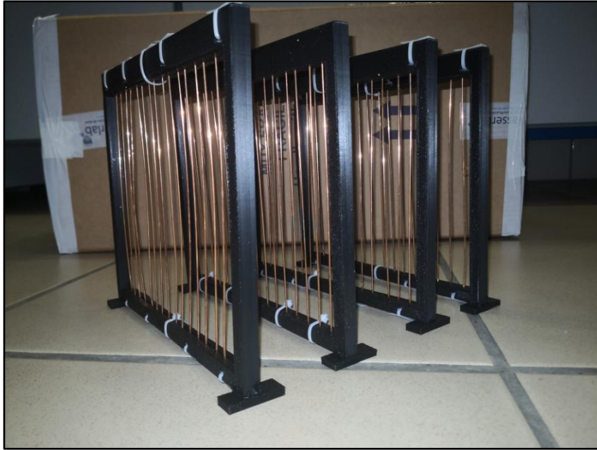
Figura 6-13. Red metálica ensamblada para los experimentos
