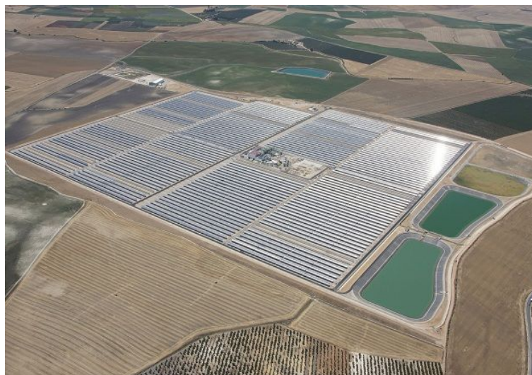
Figura 2.1 Vista aérea de una planta termosolar de tecnología cilindro-parabólica. Está compuesta por sectores de placas y en el centro se encuentra la central que contiene la turbina y el alternador.
