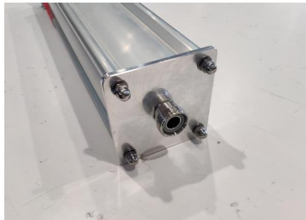
Figura 2.14 Boquilla inferior (Salida de material)
