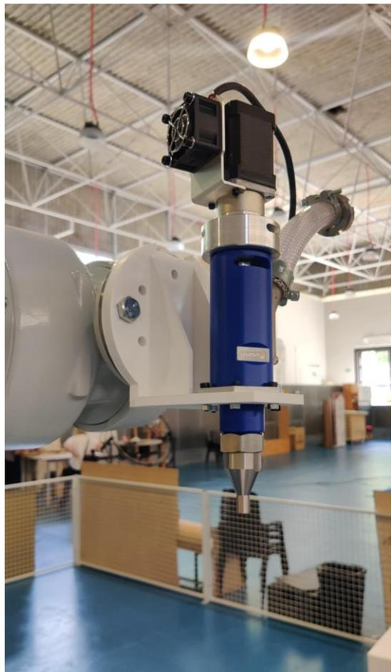
Figura 2.16 Imágenes del extrusor y la anilla de acople instalada
