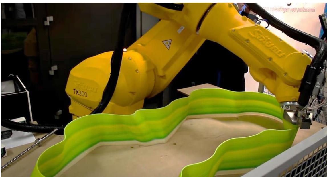
Figura 1.6. Robot Staubli imprimiendo en 3D con plástico.
