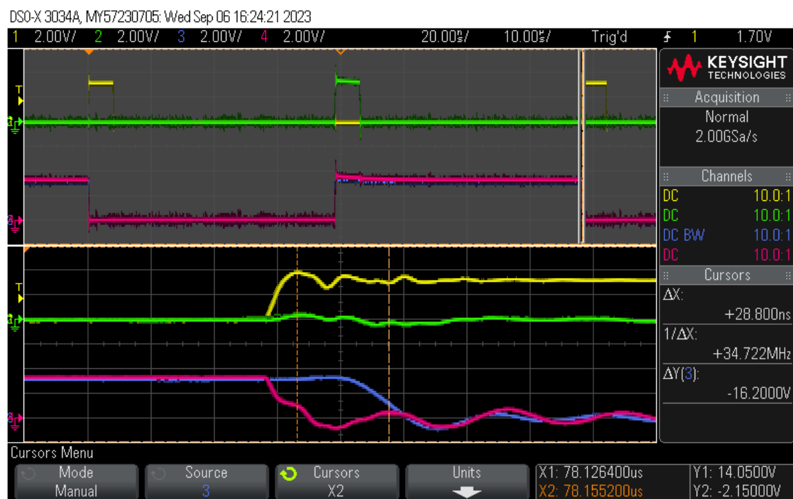
Figura 5-9. Captura de osciloscopio aplicando zoom en la zona de bajada de las fases 5 y 6
