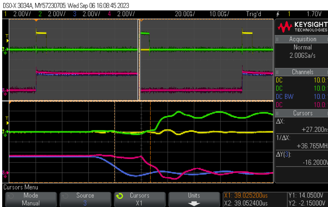
Figura 5-6. Captura del osciloscopio aplicando zoom en el desfase entre Ph3 y Ph4
