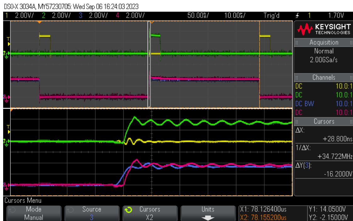
Figura 5-8. Captura de osciloscopio aplicando zoom en la zona de subida de las fases 5 y 6
