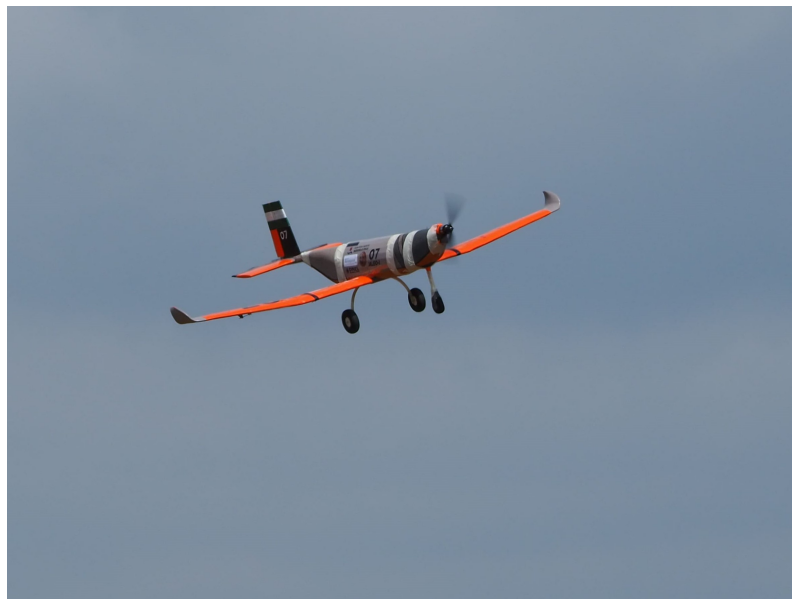
Figura 1.3 Primer vuelo del Jaleo-I diseñado y construido por el equipo VANTUS AeroTeam. De esta aeronave se extraen posteriormente los modelos de resistencia aerodinámica a utilizar en el presente trabajo, así como los datos de empuje y par proporcionados por su hélice en estudios en túnel de viento.
