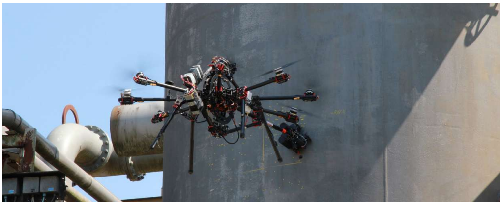
Figura 1.1 Dron para inspección de infraestructuras diseñado y fabricado por FADA-CATEC.
