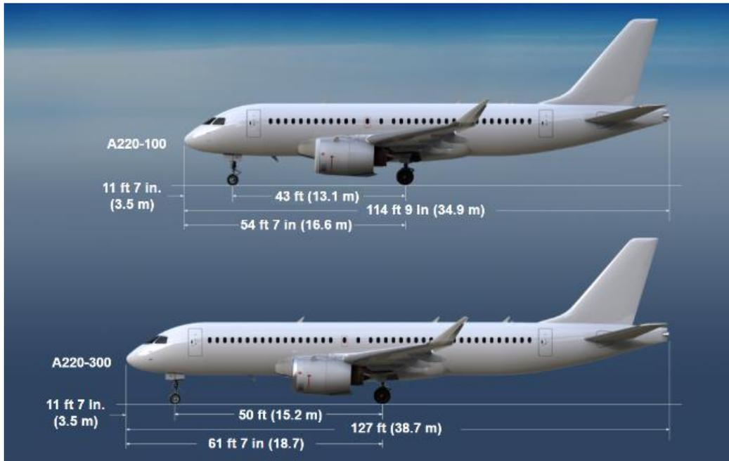
Figura 1-3. Comparación de las dimensiones del A220-100 y del A220-300 [6]
