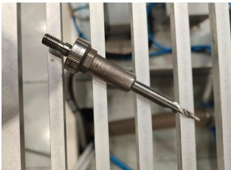
Figura 1-11. Broca de 4.1 mm de diámetro utilizada para el taladrado avellanado del A220
