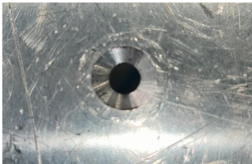
Figura 1-12. Ejemplo de taladro avellanado realizado sobre una probeta
