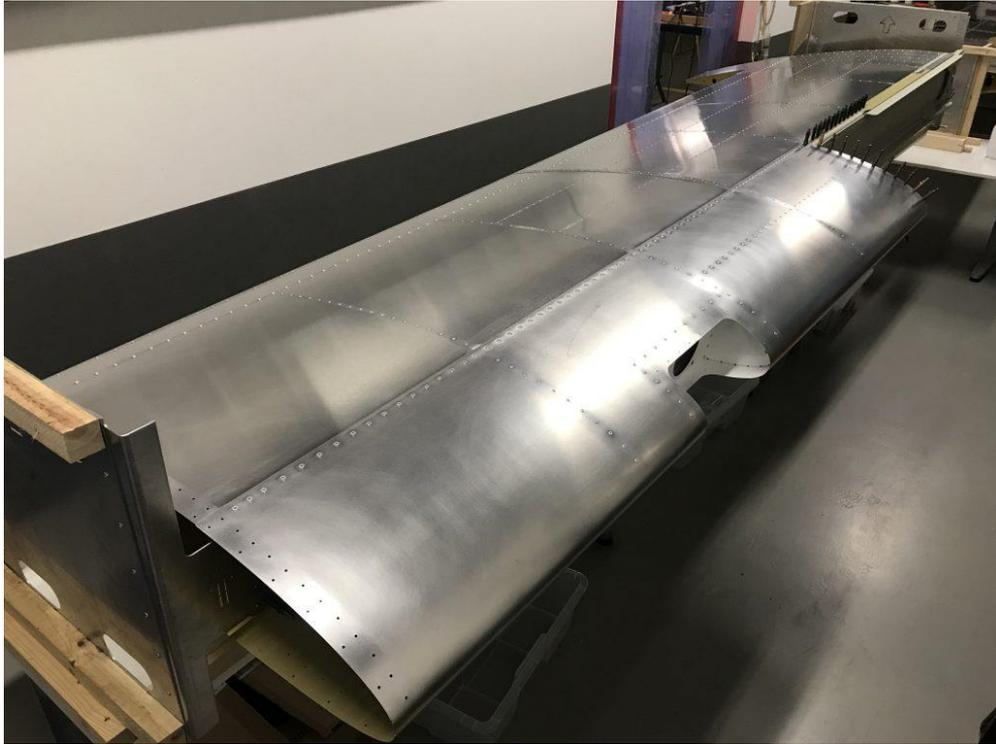
Figura 1-7. Borde de ataque del ala baja del Sling 2 [14]
