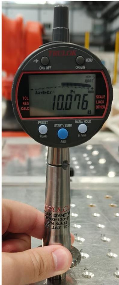
Figura 3-4. Medida del avellanado de un taladro de 4.9 mm de diámetro con el calibre de Trulok
