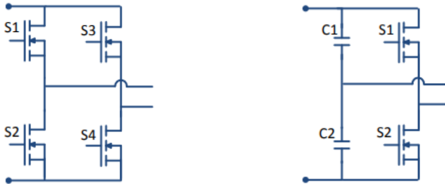
Figura 20. Inversor de puente completo (izquierda) e inversor de medio puente (derecha). Fuente [32].
