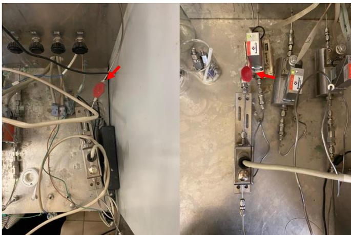
Figura 3-67: Válvulas de corte de salida del coriflow Catalyxx A y B
