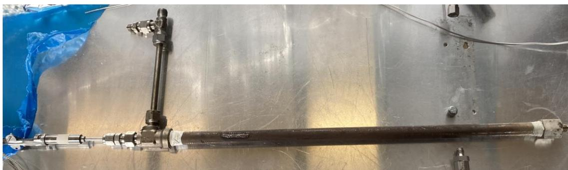
Figura 3-4. Reactor tubular y conexiones
