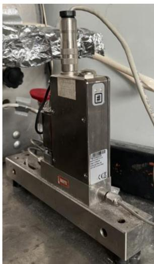
Figura 3-8. Medidor de Coriolis (CoriFlow)
