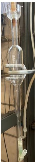
Figura 3-38: Medidor de flujo (burbujímetro)
