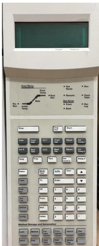
Figura 3-25: Panel de control del cromatógrafo
