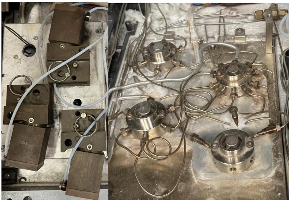
Figura 3-24: Caja de válvulas
