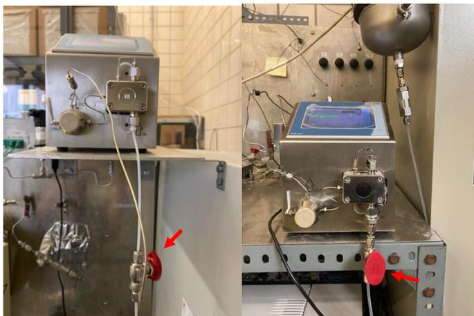
Figura 3-66: Válvulas de corte de entrada a la bomba Catalyxx A y B
