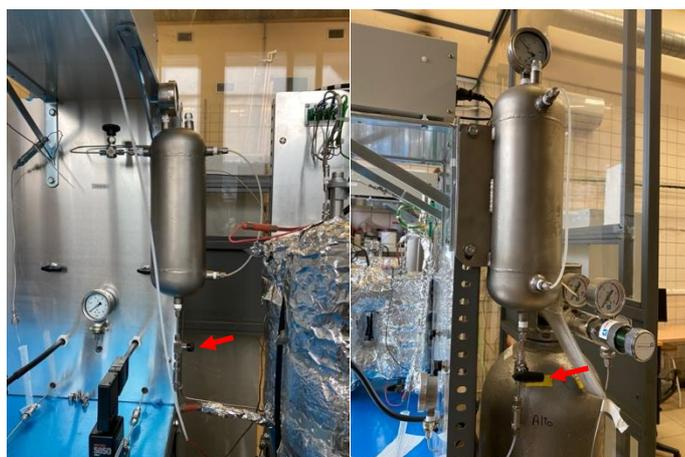
Figura 3-68: Válvulas de corte de entrada a la bomba Catalyxx C y D
