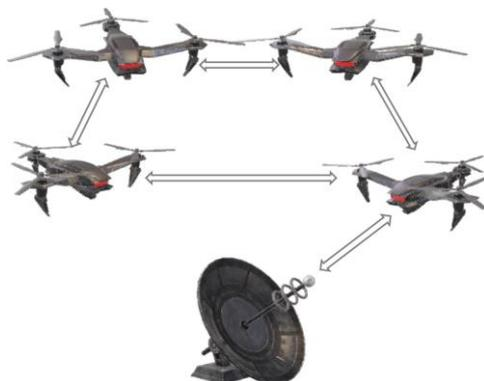
**Figura 1-9.** Esquema de comunicaciones de un enjambre de UAVs [9].
