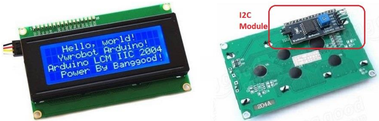
Figura 52 – Display LCD de 20x4 caracteres con módulo de comunicación I2C
