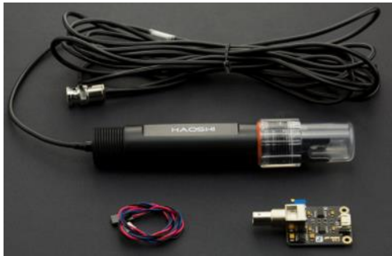
Figura 36 – Sensor de Ph de electrodo de vidrio SEN0169 DFRobot
