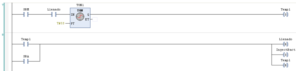
Figura 3.5 Control inyección bacterias.
