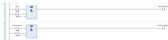
Figura 3.9 Control valvula río y terciario.
