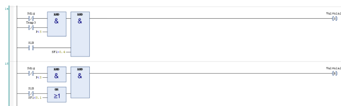
Figura 3.7 Control válvula fango tanque 1.
