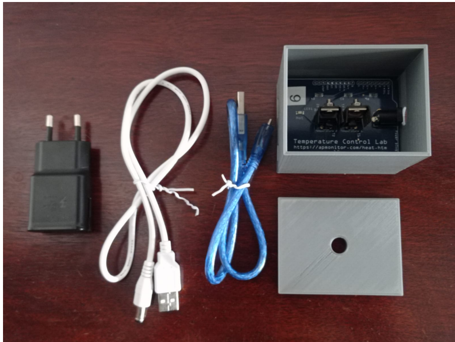
Figura 1.2 Ejemplar de TCLab empleado.
