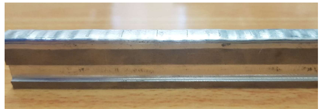
Figura 58. Trozo de Carril Corrugado
