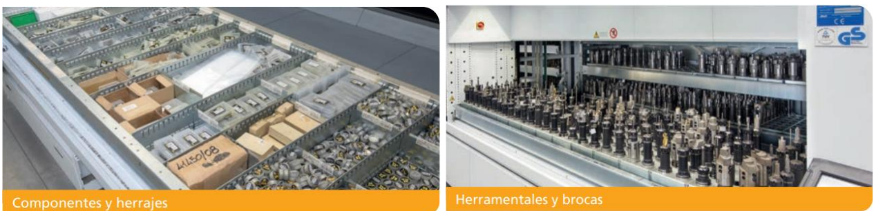
Figura 5-10: Materiales almacenados en la planta con el "Modula vertical"
