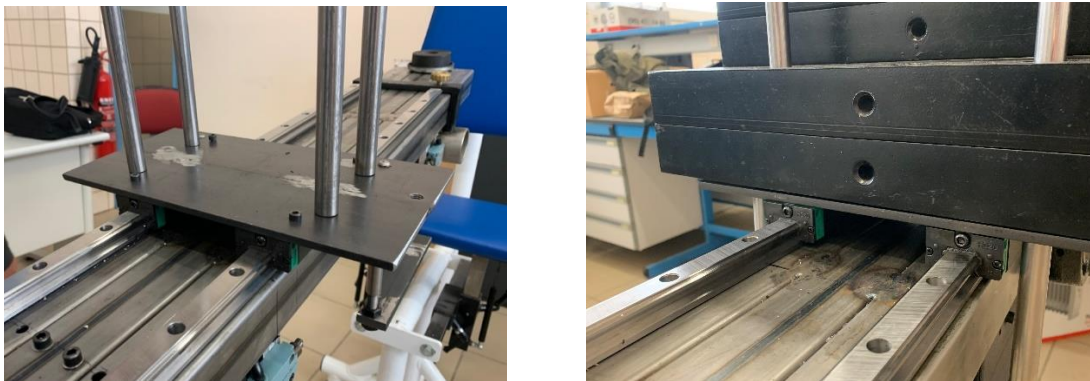
Figura 3.8. Detalle de la base plana atornillada a los 4 patines situados sobre las guías.
