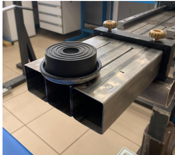
Figura 3.30. Pieza silentblock que actúa como zona de impacto.
