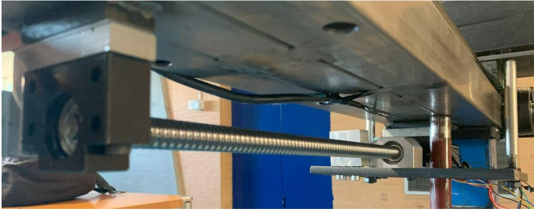
Figura 3.11. Detalle del husillo de bolas atornillado a la cara inferior de la viga.
