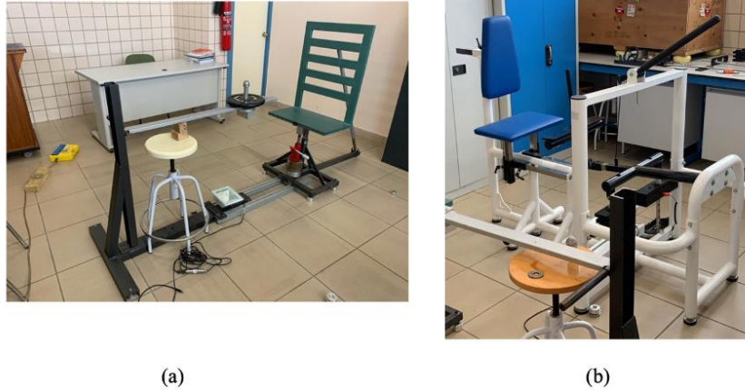
Figura 1.1. Versiones primera (a) y segunda (b) del dispositivo mecánico diseñado para la medida de las propiedades del tríceps sural.
