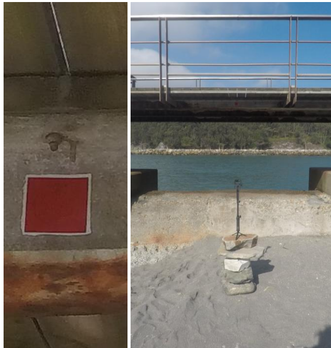
Figura 5-66. Diana colocada en la viga objeto de estudio (izq) y sensor de visión computacional (der).
