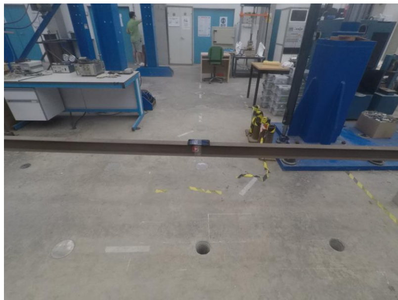
Figura 5-25. Móvil utilizado como acelerómetro.
